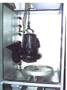
Skapet innvendig. Pumpen senkes ned på en roterende skive, dysene ses bak til venstre.
